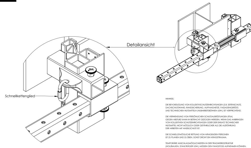
DEN ANSCHLAGPUNKT SO WÄHLEN, DASS EIN PENDELSTURZ VERHINDERT WIRD. DIE ANSCHLAGEINRICHTUNG MUSS IN ALLE ZU ERWARTENDE RICHTUNGEN BELASTBAR SEIN.
